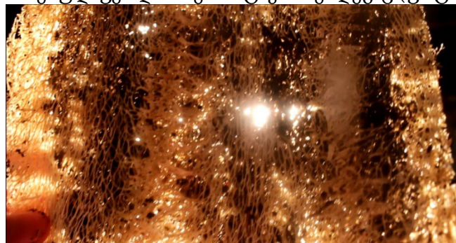
ფოტო 6 გეოხალიჩა “გეოეროლუფამატი”ს რულონის გაშლის შემდეგ გეოხალიჩაში დარჩენილი ნიადაგის და მცენარე კონდარის თესლების ნარევის საერთო ხედი.
