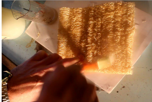
ფოტო 4. გეოხალიჩა “გეოეროლუფამატი”-ს (ფართობი 0,0306 მ 2 ) არაამობურცულ ზედაპირზე თხევადი ბიოსტიმულატორ-სახამებლის წასმის პროცესი.
