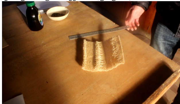
ფოტო 1 მცენარე ლუფას ნაყოფების სიგრძეზე გაჭრის და ერთმანეთთან შეკავშირების შედეგად მიღებული სატესტო გეოხალიჩის საერთო ხედი
